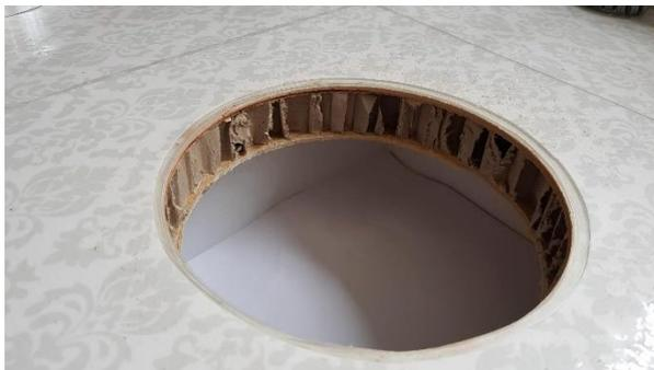
Leichte Platten sind meistens mit Kartonwaben verstärkte Platten, z.B. IKEA-Bauweise sind für den Einbau nicht geeignet
